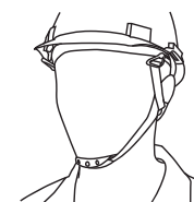
Barbucqueo de 3 puntos de apoyo, obligatorio para trabajos en altura.
